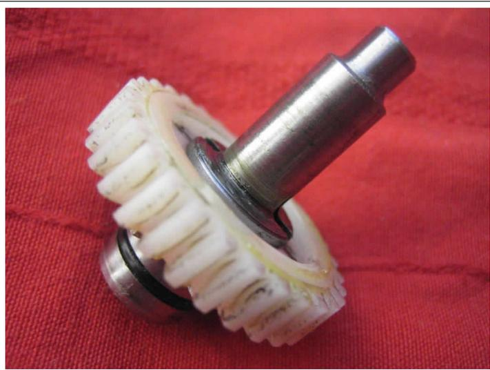
Nun kann das Golf-Ritzel mit Hilfe eines Hammers auf die Welle leicht aufgeschlagen werden, sodass es hält und der Rest mit dem Schraubstock aufgedrückt werden kann.
