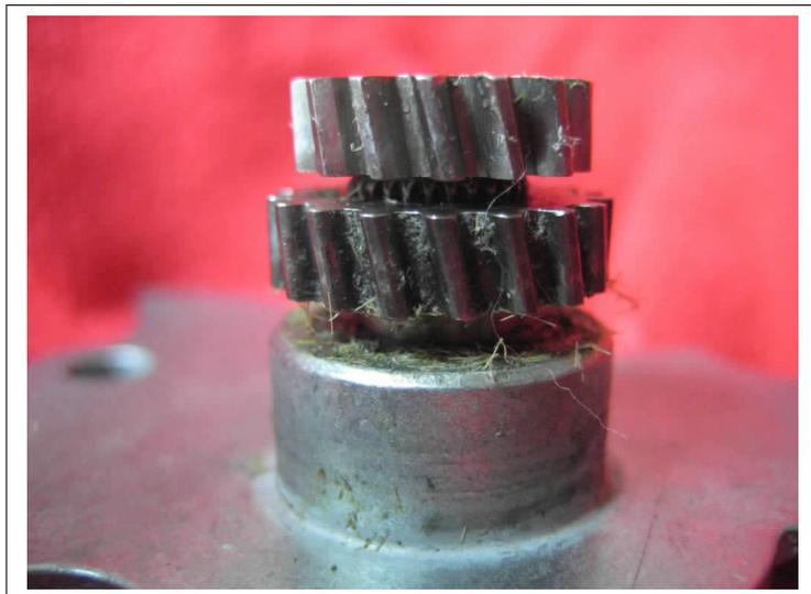
Die Trägerplatte mit dem Ritzel in den Schraubstock einspannen und den „Pilz“ (grün) bis auf die Höhe (blau) des Ritzels herunter feilen/flexen. Danach das Ritzel abhebeln. Dazu am besten einen Abzieher benutzen, es geht aber auch mit einem oder zwei Schlitzschraubendrehern (vorsichtig). Nun kann die Welle aus der Trägerplatte herausgezogen werden.
