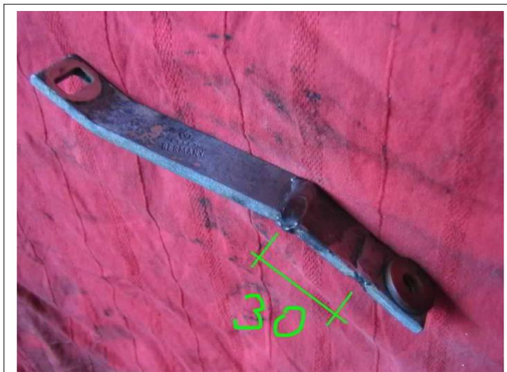
Somit ist der originale Hebel noch vorhanden und der verlängerte Hebel kann ausgebaut werden, falls das Auto mal gewechselt werden sollte.
