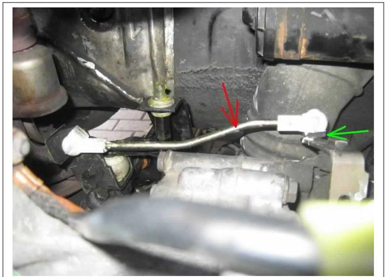
Einen Schlitzschraubendreher zwischen Gehäuse und Sicherungsclip (**grün**) einstecken und mit ihm den Clip zur Seite aufhebeln (**rot**). Danach kann die Wählstange nach oben abgehoben werden.
