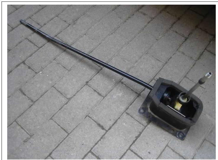
Um an die Kugel zu gelangen, muss zuerst die Lagerbuchse (rot) aus der Schaltbox heraus gedrückt werden. Da diese Buchse eh ausgetauscht wird, ist es am einfachsten, sie herauszuschneiden.
