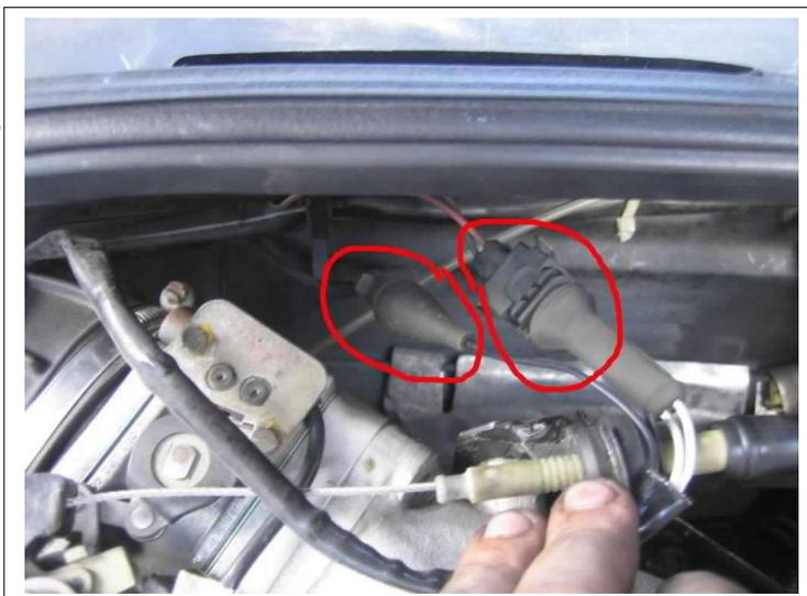
Nun kann das Hitzeblech mit den 6 Befestigungen (rot) abmontiert werden.
