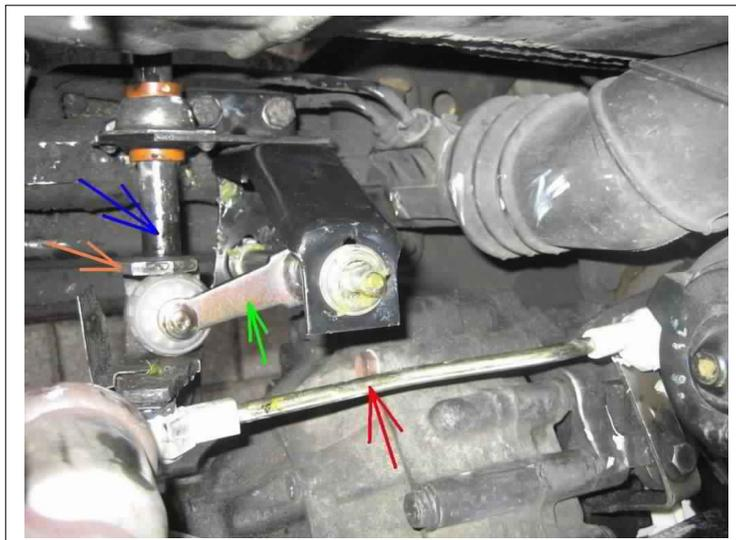
Damit die „Kugel“ von der Umlenkwellen leichter aus dem Wählhebel (**orange**) rutscht, sollte die Schaltstange (**blau**) komplett nach vorne, also zum Motor hin, gezogen werden.
