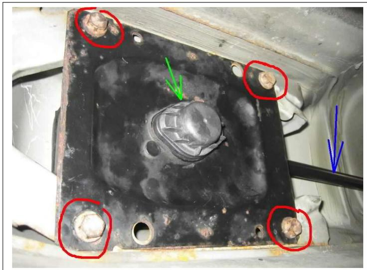
So sieht dann die Schaltbox mit der Schaltstange aus.
