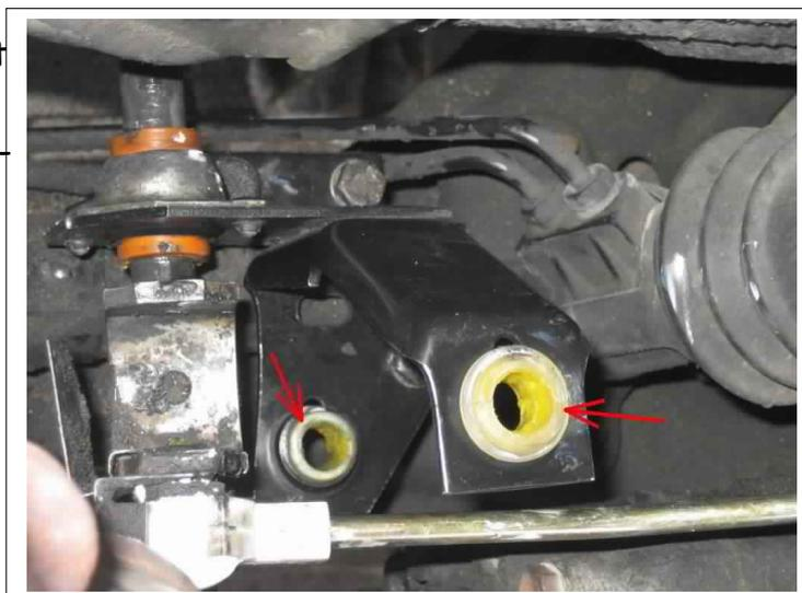
Danach die Sicherungsklammer wieder auf die Umlenkswelle aufstecken.
