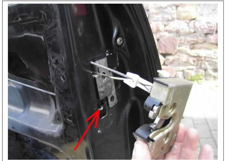
Das mitgelieferte Schlitz-Flacheisen an die Türe anschrauben.
