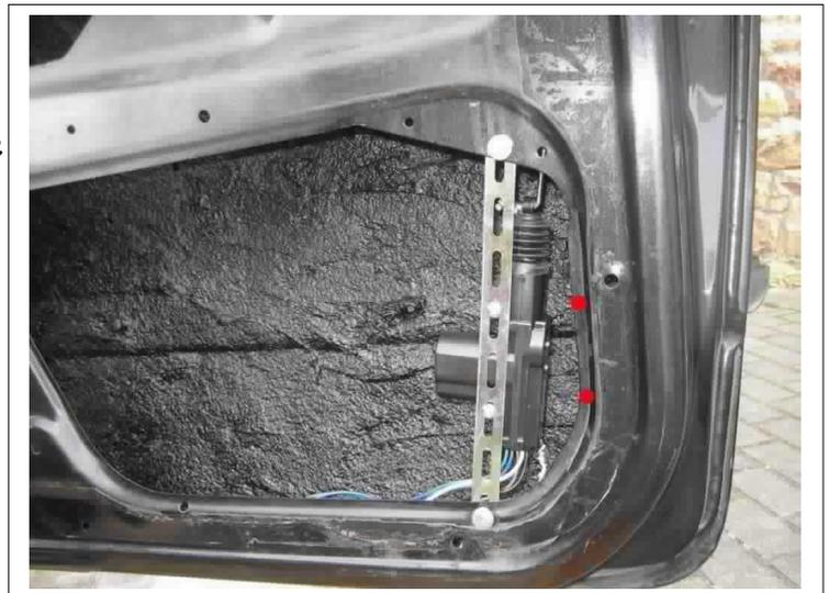
Hier sieht man, dass die Zugstange am unteren Ende um 90° gebogen ist und mit einer blanken Lüsterklemme am Stellmotor arretiert wurde. Die Schrauben der Lüsterklemme am besten mit „Loctite“ sichern.
