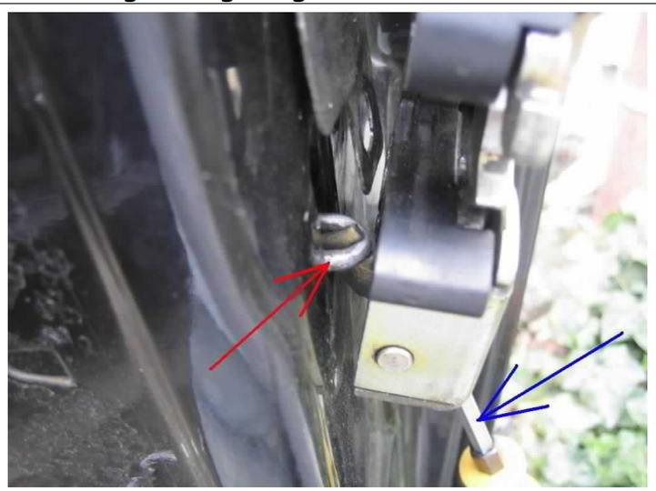
Jetzt liegt der Sicherungshebel frei. Links oben ist die Stange zum Türpin zu sehen.
