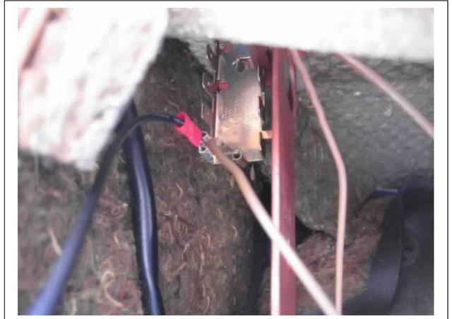
Das rote Plus-Kabel wird mit Hilfe einer Flach-Steckhülse an die Klemme 30 (Dauerstrom +) hinter der ZE angeschlossen.
