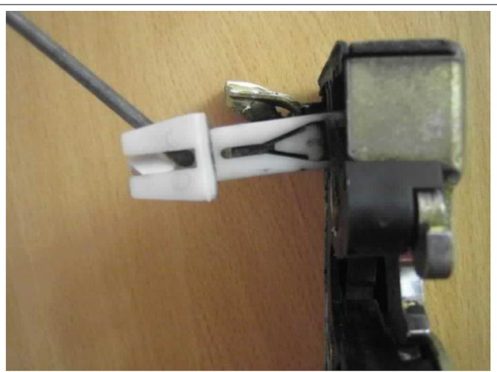
Bevor die Zugstange eingehängt wird, muss sie auf 4mm gekürzt werden.
